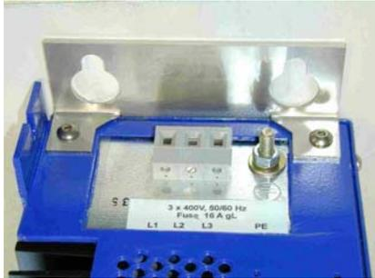
Montagewinkel auf der Geräteoberseite montieren
