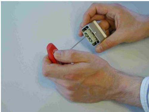
Anzugsdrehmoment: 1 Nm (zul. Moment für Schraubendreher = 1,2 Nm)
